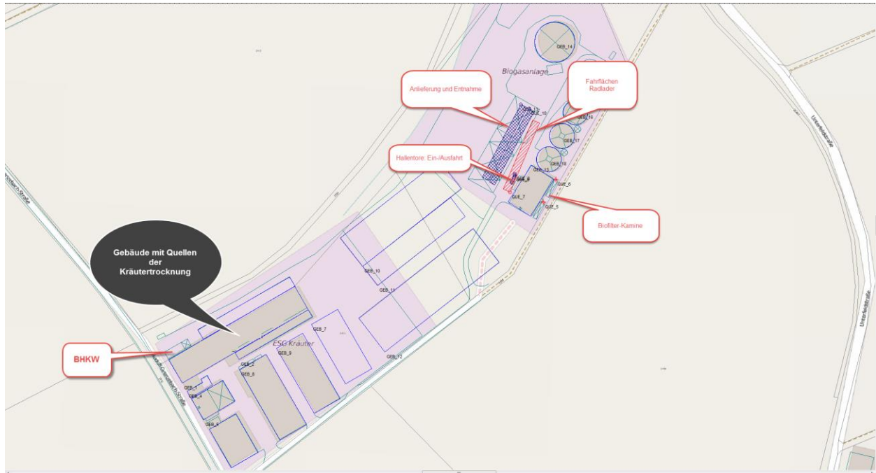
Abbildung 3: Betriebsgebäude mit Kennzeichnung der Lager der Emissionsquellen der verschiedenen Anlagenteile.
