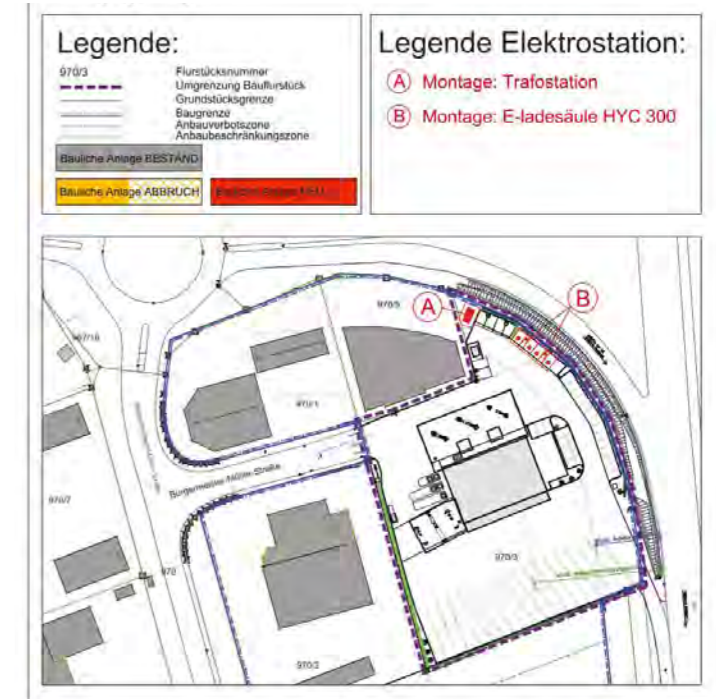
Lageplan Erweiterung um vier Elektroladeplätze inkl. Trafostation. Planzeichnung TS Planung + Projektmanagement GmbH
