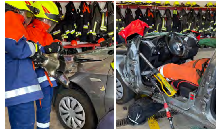
Im Bild links wird der Spreizer eingesetzt; rechts ein Rettungszylinder, um eine Person aus einem Unfallauto zu befreien. Fotos: Maximilian Scheerer
