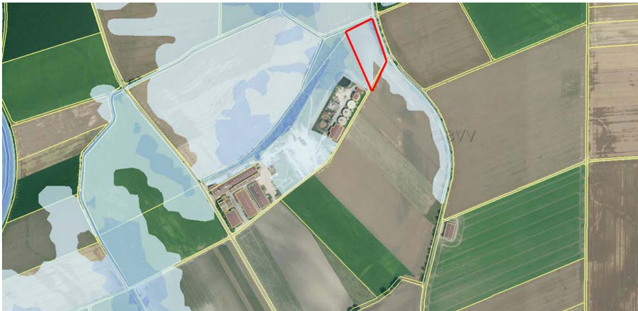
Abbildung 2.1: Skizzierte Lage des Untersuchungsgebietes (rote Linie) mit Darstellung des hundertjährigen Überschwemmungsgebiets (Wassertiefen; © Bayernatlas)
